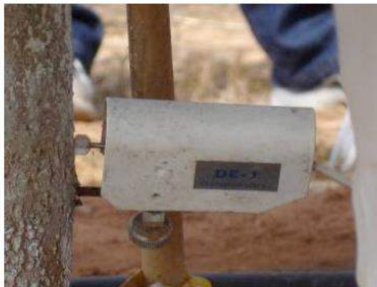
Figura 3 – Instrumentos de medição e transmissão de dados sem fio para monitoramento do desenvolvimento de cultura de abacates
