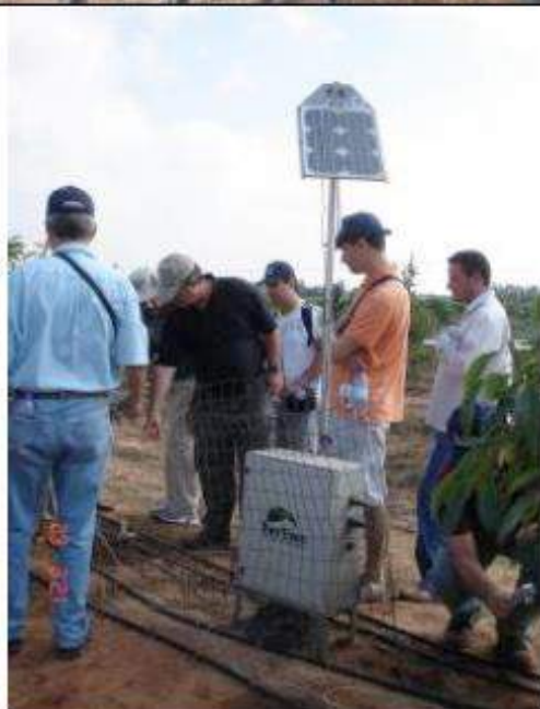
Figura 3 – Instrumentos de medição e transmissão de dados sem fio para monitoramento do desenvolvimento de cultura de abacates
